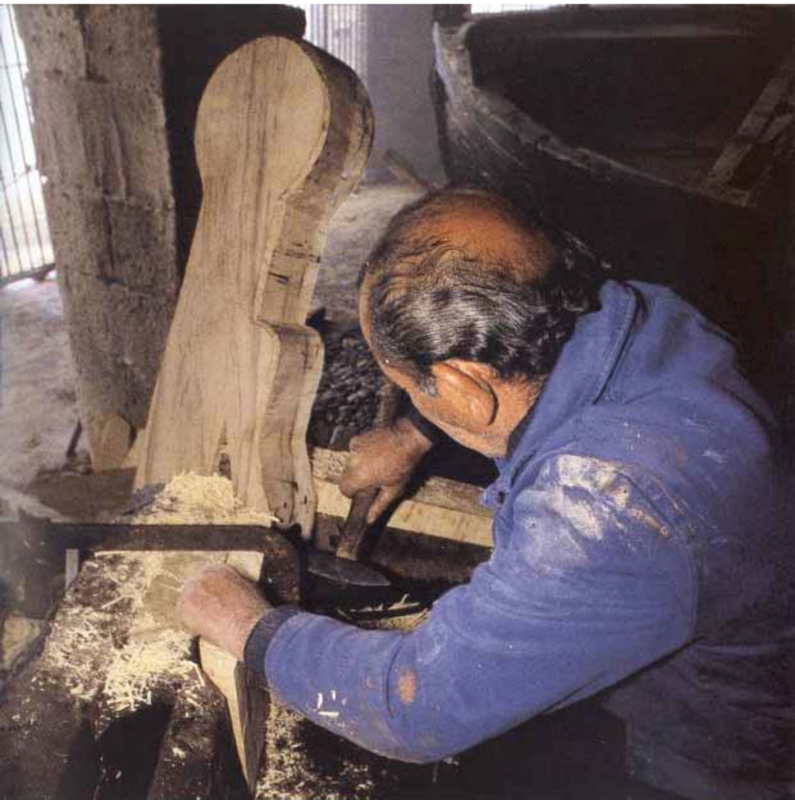
intervento del mastro d'ascia sulla prua del "parascarmo"
