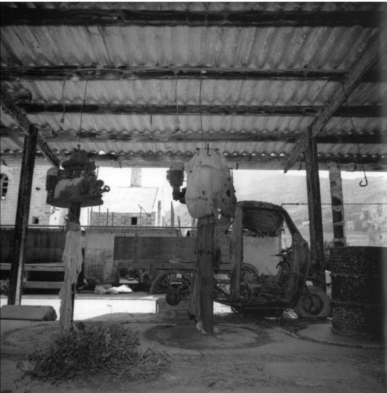
torchi per l'estrazione dell'olio di pesce
