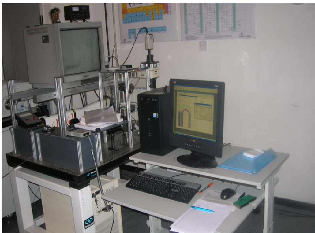
FIG. 2.4. Sistema di acquisizione LA-ICP-MS, Perkin Elmer DRCE-Laser microprobe ArF 193nm Geolas 200Q , Microlas (PC interfacciato allo strumento).
