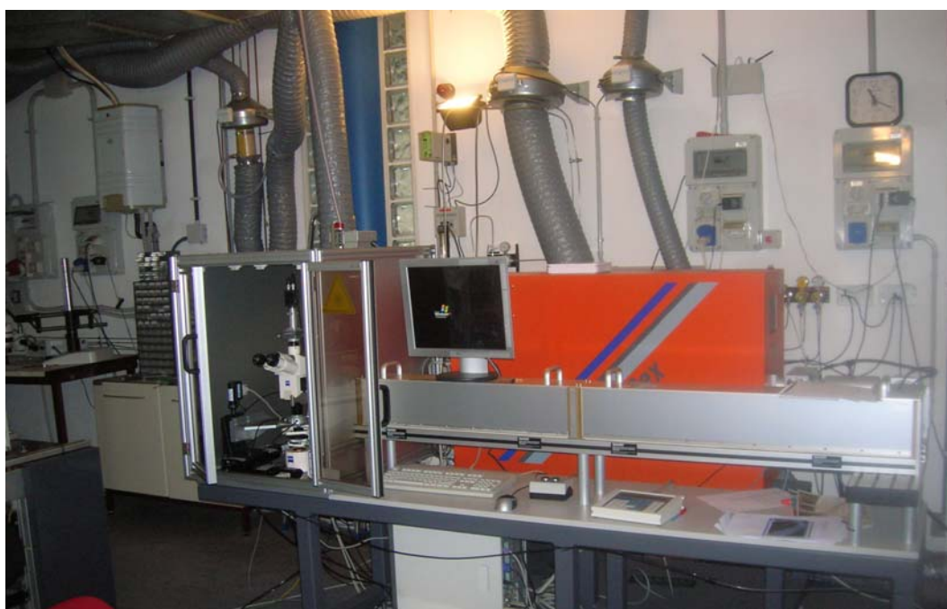
FIG 2.2. Sistema di acquisizione LA-ICP-MS, Perkin Elmer DRCE-Laser microprobe ArF 193 nm Geolas 200Q, Microlas (Laser ablation).
